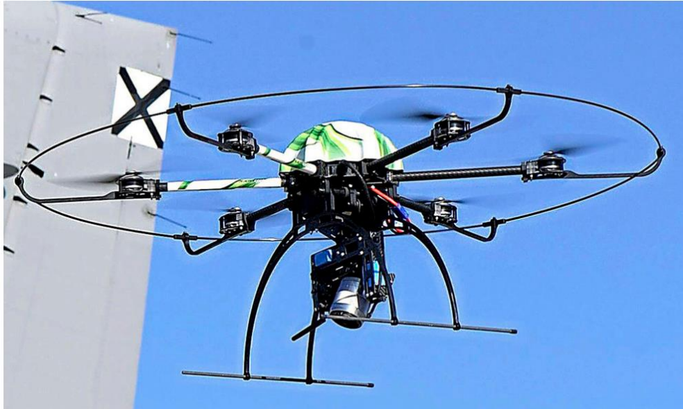
Un aracnocóptero inspecciona la cola de una aeronave militar. | ARBÓREA INTELLBIRD
