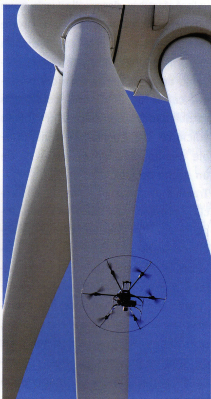
EOL6 con su nuevo sistema plegable de protección antichoques.
