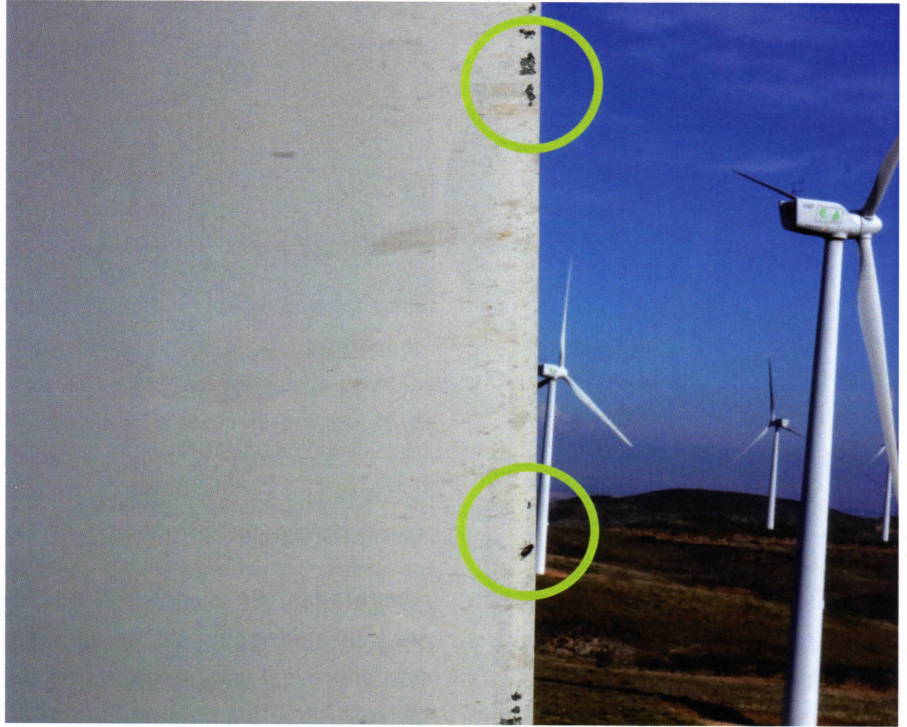
Detalle del borde de ataque dañado fotografiado por el EOL6.
