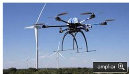
**El modelo de aeronave Eol 6 está diseñado específicamente para las revisiones de aerogeneradores Foto Arbórea**
