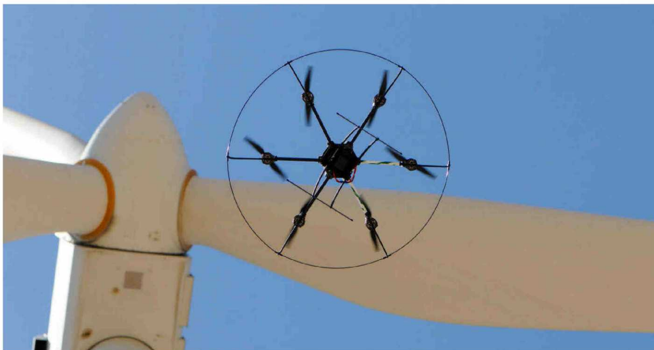
El dron Aracnocóptero, fabricado en el Parque Científico de la Universidad de Salamanca, realiza una inspección digital de palas en un aerogenerador. ARBÓREA INTELLBIRD
