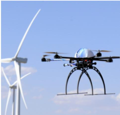
stato battezzato **Aracnocóptero** e si occupa dell'ispezione delle turbine al fine di garantirne il regolare funzionamento. Sviluppato dalla Arbórea Intellbird, spin off dell'Università di Salamanca di cui fa parte anche Iberdrola, **il drone è dotato di telecamere e sensori ad alta risoluzione** per controllare le turbine in volo senza bisogno di un pilota riducendo così tempi di scansione e costi di supervisione.
